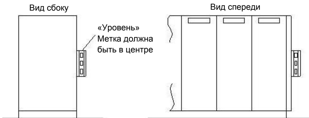
Рис. 13. Способ проверки правильности сборки после транспортировки
